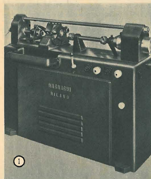
1 - Una ricalcatrice idraulica per la preparazione degli sbozzati da passare alla rullatura. Nel basamento è installata la centralina per la messa in pressione dell'olio da inviare ai martinetti delle ganasce che serrano il pezzo durante la ricalcatrice. Il pezzo viene riscaldato elettricamente e l'im-
