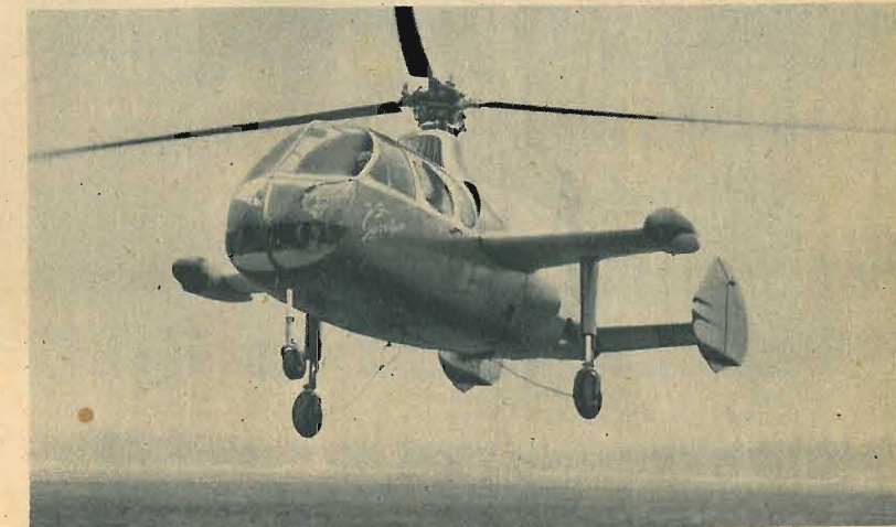
FAIREY Gyrodyne. Elica anticoppia laterale per la propulsione. Rotore di 15,9 m di diametro; 2040 kg; potenza 505 cav; velocità 200 km/h.
