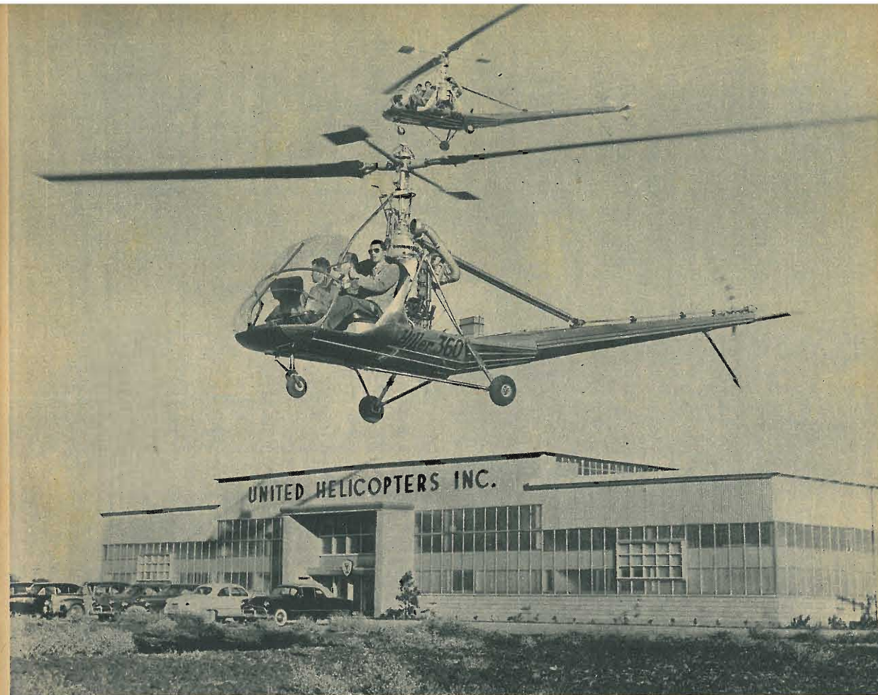
HILLER 360. Monorotore ad elica anticoppia posteriore e asta di stabilizzazione giroscopica. Triposto; un rotore di 10,4 m di diametro; motore Franklin da 178 cav; peso complessivo 960 kg; velocità 175 km/h.
