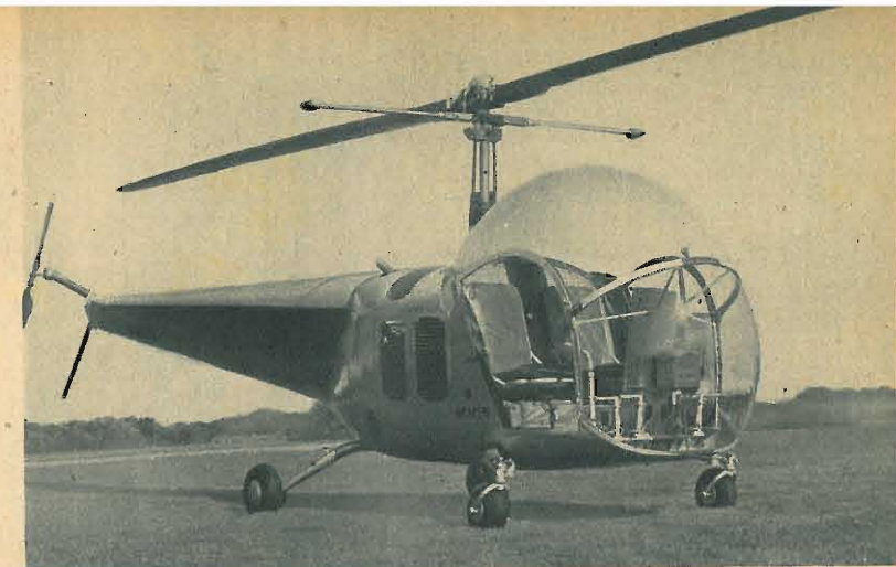
BELL 47-D. Biposto. Rotore a 2 pale di 10,7 m di diam. stabilizzato con asta giroscopica; 1000 kg; motore Franklin da 178 cav; vel. 150 km/h.
